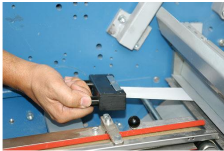
Messtechnische Überprüfung der Einstellung der Falzwalzen
