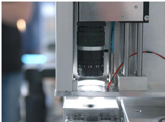
Videokamera zur Positionserfassung
